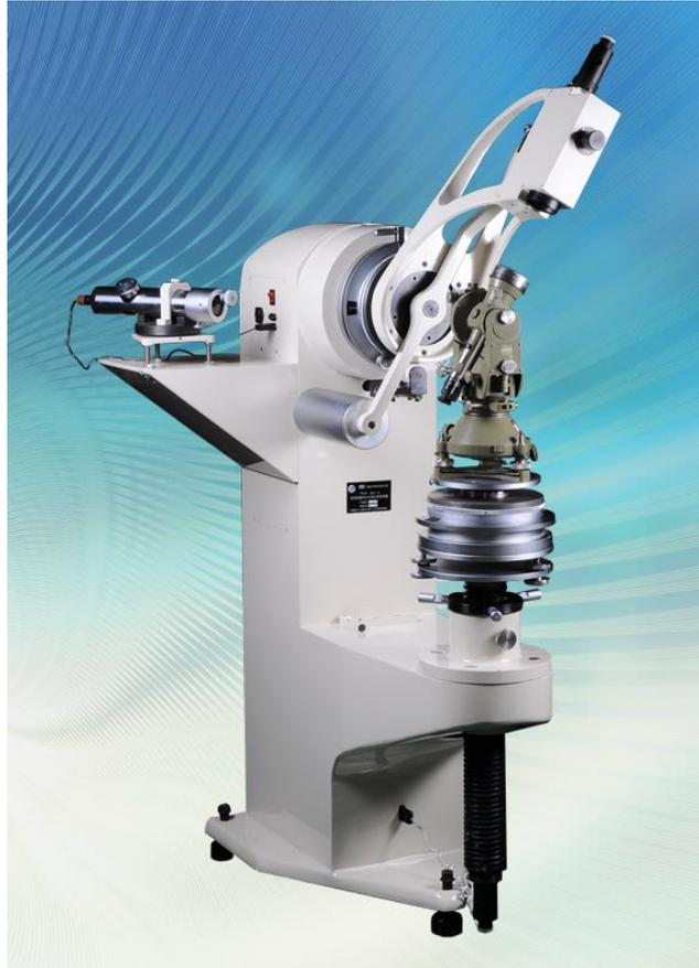
仪检定装置，如图 6 所示，以我所研制的 JQY-1A 高精度经纬仪水准仪检定装置为例：该检定装置由立式多齿分度台、卧式多齿分度台、检调管、自准直平行光管和仪器底座组成。通过自准直平行光管与卧式多齿分度台的转动，构成任意角度垂直方向无穷远目标。检定水准仪  $i$  角时，利用多齿分度台的分度精度，由置平于工作台上被检水准仪两相对  $180^\circ$  水平位置，提供对水准仪  $i$  角检定的标准方位线，以水准仪横丝在分划板竖丝上读数  $d_1$  (带正负号，格)，卧式多齿分度台转  $180^\circ$ ，望远镜旋转  $180^\circ$ ，瞄准光管分划板，同样读数  $d_2$ ， $i$  角计算式如下：
